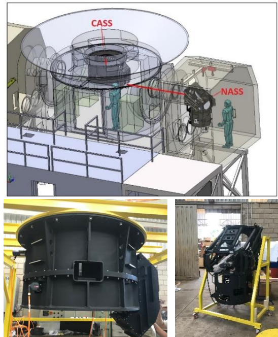
No topo: Visão geral do projeto mecânico do NACOS. Embaixo: NASS e CASS, componentes do NACOS, em processo de integração e alinhamento óptico nas dependências da ALFA Engenharia (Araraquara, Brasil).
