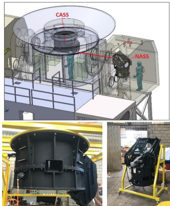
Arriba: Descripción general del diseño mecánico de NACOS. Abajo: NASS y CASS, componentes de NACOS, en proceso de integración y alineación óptica en las instalaciones de ALFA Engenharia (Araraquara, Brasil).
